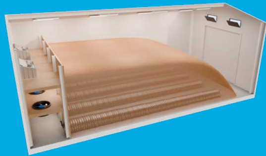
Bulkbewaring, halfronde kanalen
